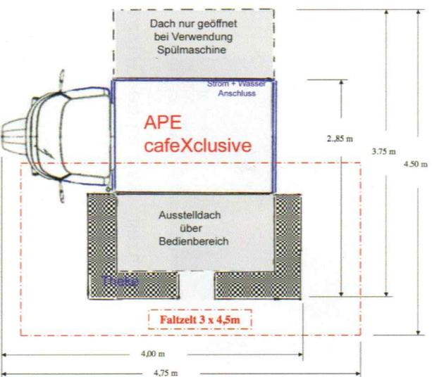
Wir benötigen folgenden Stromanschluss: entweder 400 Volt, mind. 16 Ampere abgesichert oder 3x 230 Volt, jeweils mit 16 Ampere abgesichert.
